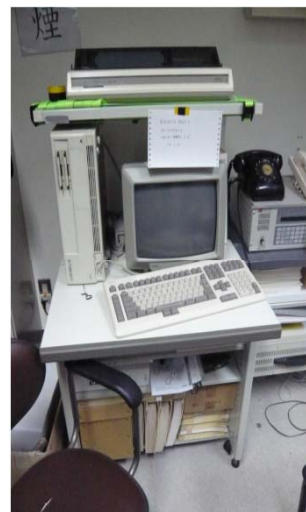
サーバ等が耐震固定されていないもの有り
