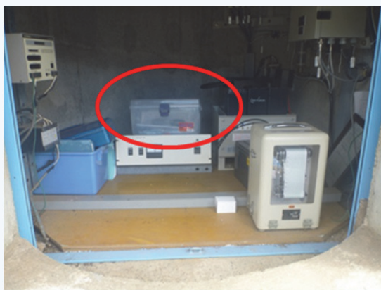
津森雨量局 計測機器 一部計測機器の配置がずれている
