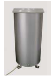
写真-1 光ファイバ式雨量計 (ファラデー型応用センサ)
