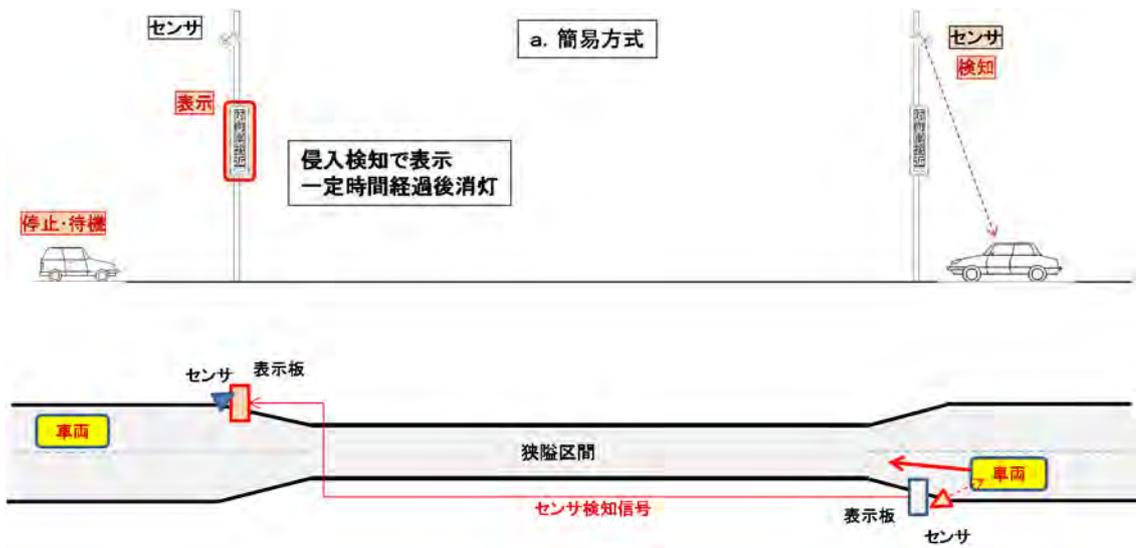
図-3 簡易方式のセンサ配置と情報板表示イメージ
