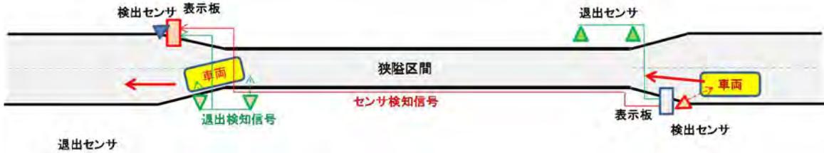
図-4 退出検出方式のセンサ配置と情報板表示イメージ
